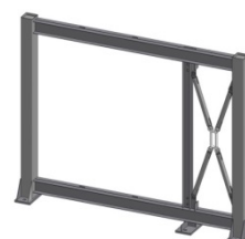
図 2 袖壁タイプのスケーリング・フレーム構造実験
