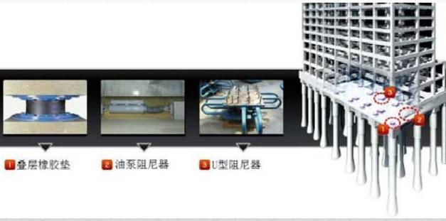
1 叠层橡胶垫 2 油阻尼器 3 U型阻尼器
